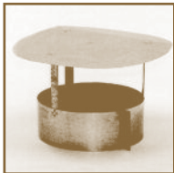
CHAPEAU PLAT POUR REJET VERTICAL réf. CP Fonction : protection pare-pluie des caissons à rejet vertical (HV) placés à l'extérieur. Diamètre des piquages : 315, 450 et 500 mm.
