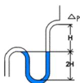
**Sur chaque tube d'évacuation de condensats, prévoir un siphon.** Un même siphon ne peut pas être utilisé pour plusieurs évacuations. Attention : le siphon doit être raccordé dans les Règles de l'Art afin d'assurer une évacuation optimum des condensats.
