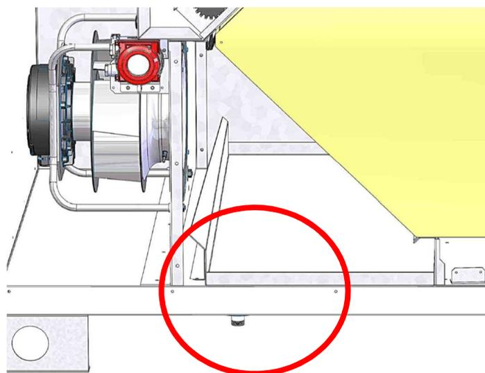
Lever manuellement le bac à condensats afin d'enlever la vis située dans la bobine. Couper ensuite le passe fil situé sur le dessous afin de permettre à la bobine de se positionner en dessous de la centrale comme indiqué sur la photo ci-dessus. Attention à la découpe du passe fil qui sert de rondelle d'étanchéité.
